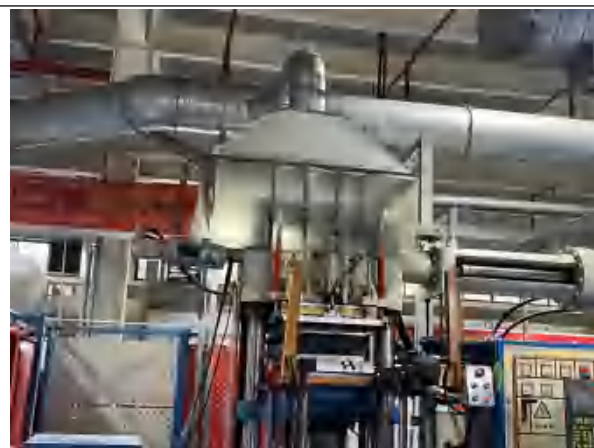
注塑机-上方设置集气罩、四周设置围蔽
