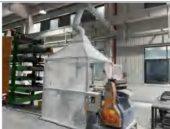
分条机-上方设置集气罩、四周设置围蔽
