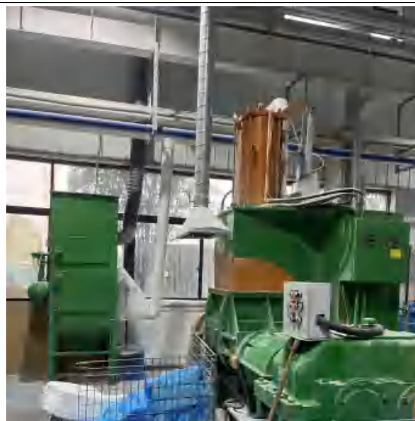
混料胶生产线-集气罩
