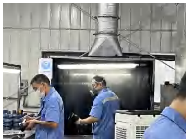
喷涂房-上方设置集气罩、四周设置围蔽/水帘柜
